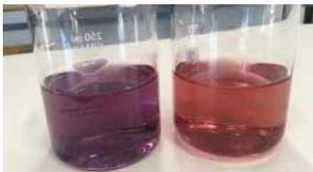
Slika 1: Sprememba barve raztopine indikatorja lakmusove tinkture v destilirani vodi iz vijoličaste (levo) v rdečo (desno) po uvajanju plina \text{CO}_2
