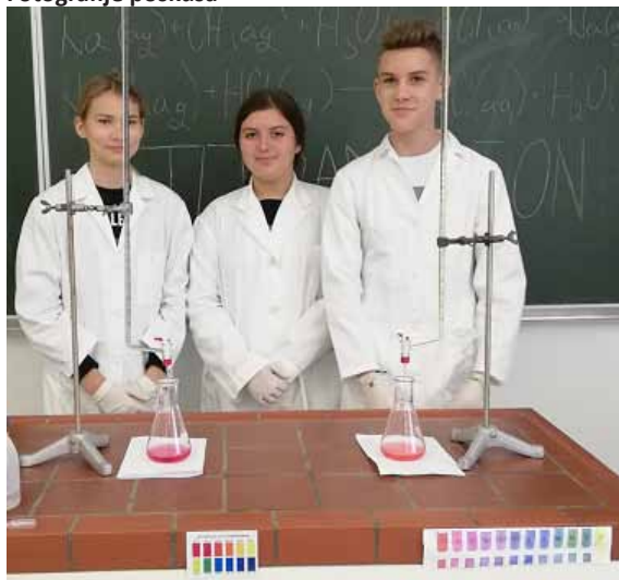
Slika 3: Aparatura za titriranje. Kislina in baza sta na levi strani obarvani z univerzalnim indikatorjem, na desni pa z ekstraktom barvil rdečega zelja
