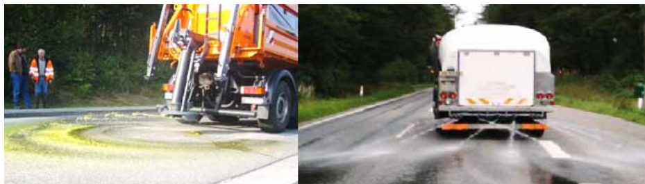
Slika 1: Posipanje z vlažno soljo in polivanje vozišča s posipalnikom za tekočine (Vir: http://diplome.fov.uni-mb.si/uni/13012Gorse.pdf )
