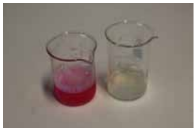
Raztopina barve za lase, ki vsebuje amonijak, pred uvajanjem ogljikovega dioksida in po njem.
